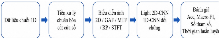
Hình 1. Quy trình thực nghiệm so sánh biểu diễn hai chiều cho phân loại chuỗi thời gian bằng mạng tích chập nhẹ
